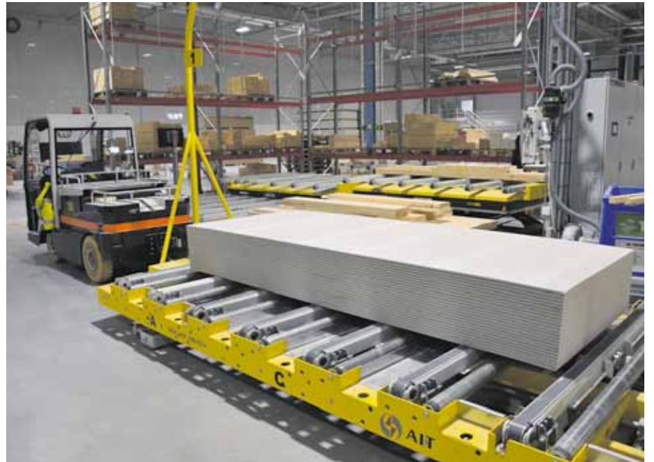
I olika delar av fabriken färdigställs väggar och tak separat, för att sedan föras över till linan.
