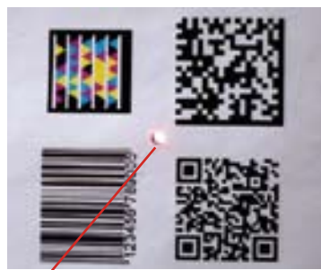
Bokodes är endast 3 mm men kan avläsas på mycket längre avstånd än traditionella märkningar.
